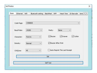
8. Проверяем нажав «Self Test», после печати страницы Self Test прозвучит звуковой сигнал.
